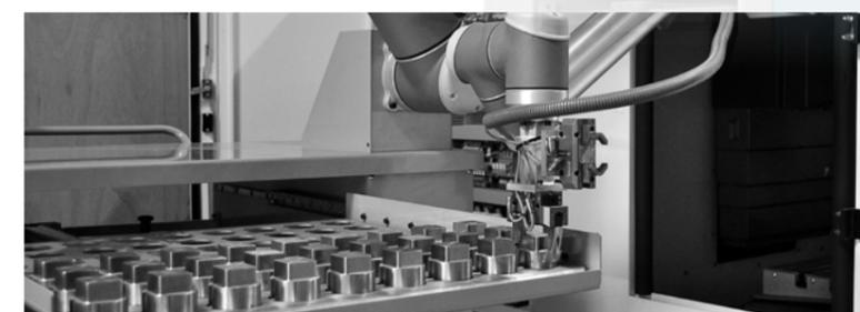
La cellule est composée d'un robot polyarticulé, de type Universal Robot UR10, intégré dans un ensemble très compact, comprenant jusqu'à 5 tiroirs de chargement et déchargement automatique de machines-outils de tous types. La cellule ACN-EVO rend les machines autonomes en se positionnant avec facilité devant celles-ci, à la place de l'opérateur.
