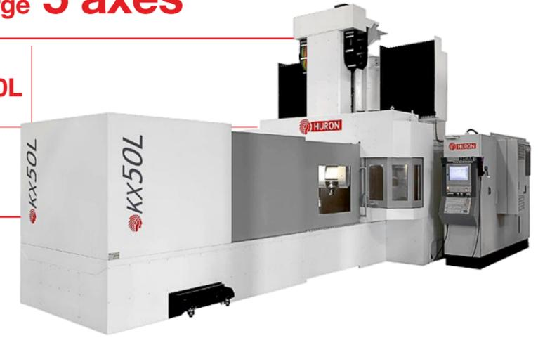
Gamme de centres de fraisage 5 axes à portique aux prestations élevées pour usinage de pièces complexes et composants critiques. La série KX Five associe dynamique et précisions élevées, permettant d'obtenir un état de surface en finition d'une très haute qualité sur les profils finis.
