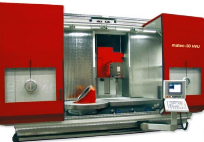
La série HVU dispose d'une nouvelle tête de fraisage qui peut être tournée autour de deux axes, permettant l'usinage sur 4 faces de pièces longues. Elle est bien adaptée aux pièces individuelles comme aux petites et moyennes séries.
